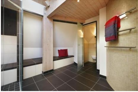
Die Wärmebank durchstößt die Wand der Dusche. Ihre langlebige und reinigungsfreundliche Oberfläche besteht aus keramischen Formteilen der Manufaktur Hilpert.
